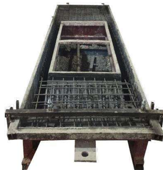
▲ نحوه اتصال و قرار گیری شابلون و پلیت ها به مش تیپ
