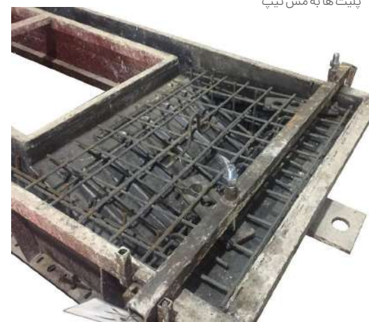
▲ نحوه اتصال و قرار گیری شابلون و پلیت ها به مش تیپ
